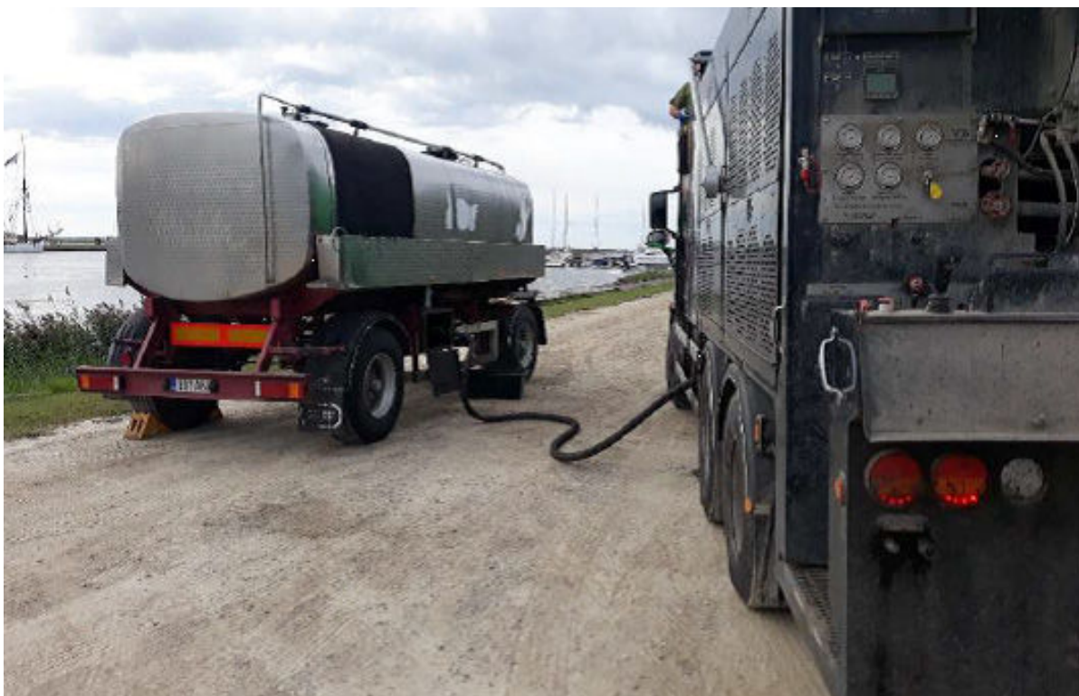
32. att. MS mašīnas piepildīšana ar bitumena emulsiju
