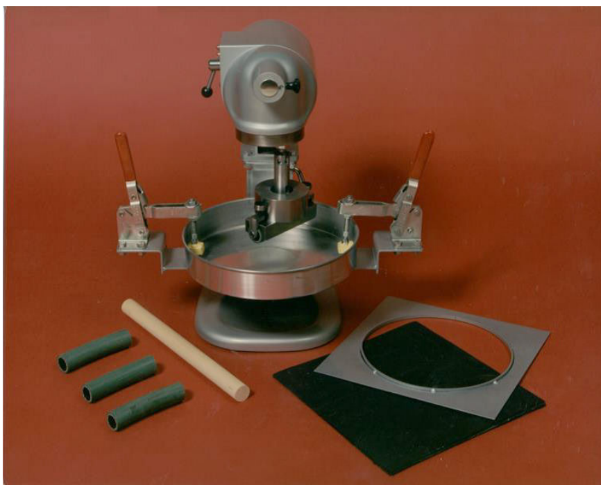
12. att. WTAT testēšanas iekārta ( www.slurry.org )
