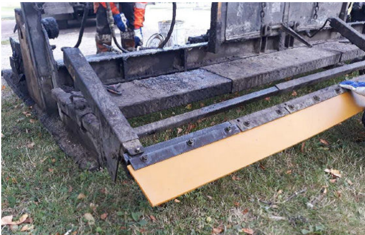
35. att. Izlīdzināšanas gumijas lentes piestiprināšana pie kastes
