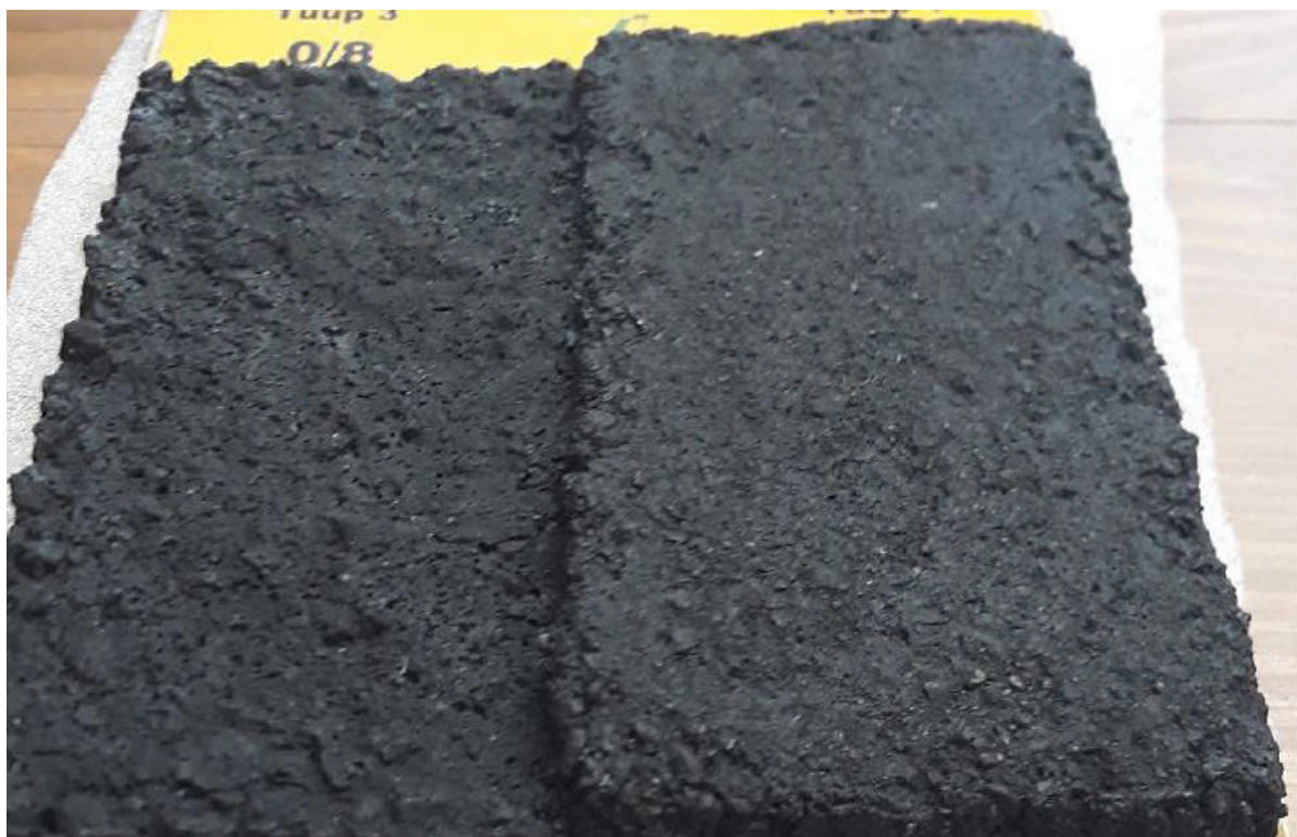
56. att. Type III (DSK 8, ŠL 8; frakcija 0–8) + Type I (DSK 3, ŠL 3; frakcija 0–2)
