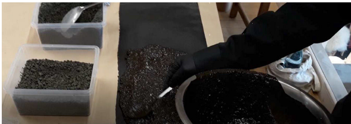
67. att. MS maisījuma ieklāšana uz speciāla materiāla laboratorijas apstākļos viegliestrādājamības novērtēšanai
