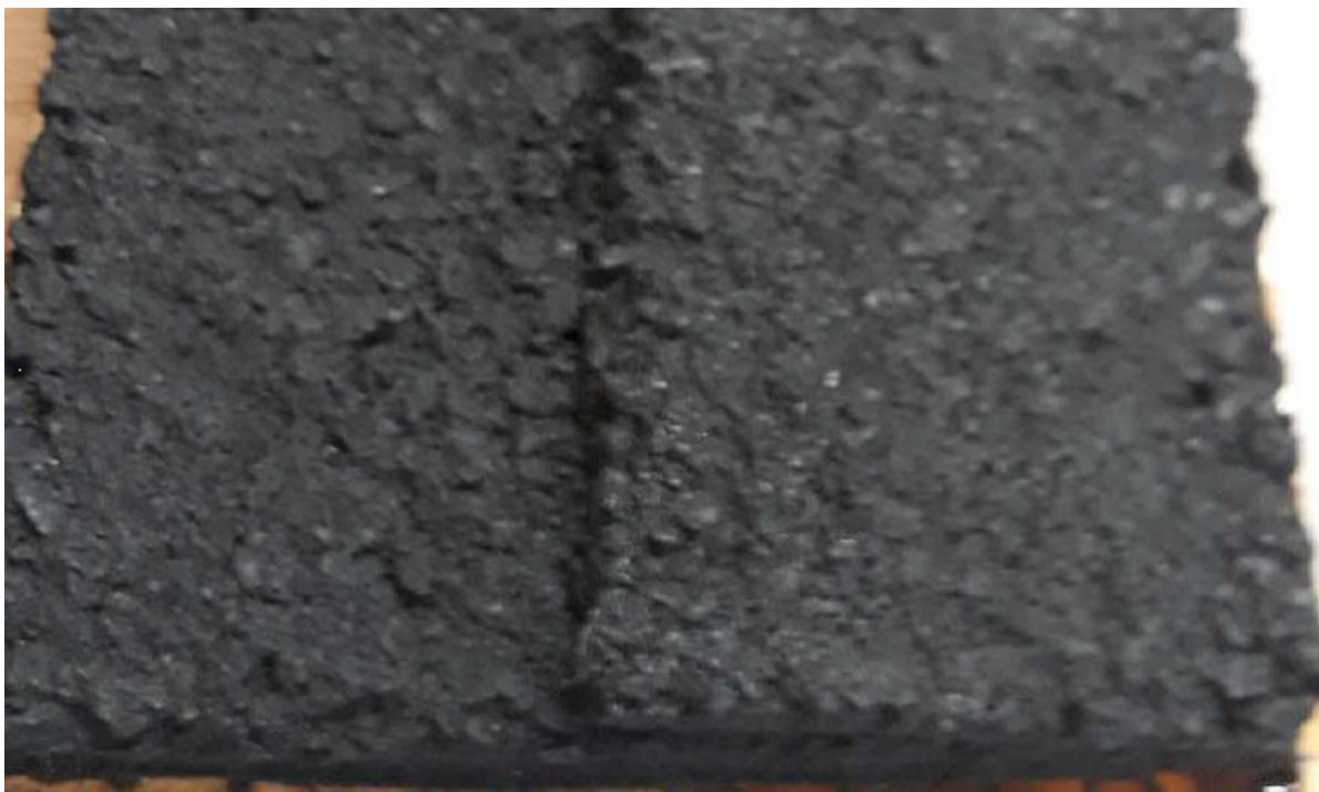
58. att. Type III (DSK 8, ŠL 8; frakcija 0–8) + Type II (DSK 5, ŠL 5; frakcija 0–4)
