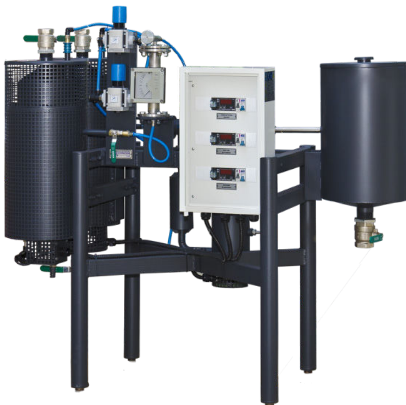
60. att. Laboratorijas iekārta bitumena emulsijas izgatavošanai
