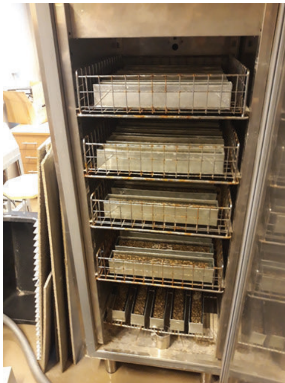
59. att. Paraugu novietojums sasaldēšanas/atkausēšanas kamerā
