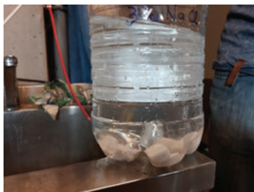
57. att. 3% NaCl šķīduma sagatavošana, izmantojot destilētu ūdeni (a) un NaCl tabletes (b)
