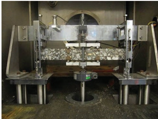
8. att. Četru punktu lieces tests prizmas formas paraugam [10]
