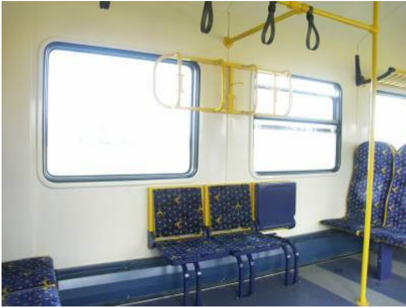
30. att. Velosipēdiem paredzēta moderna vieta pasažieru vilcienā.
