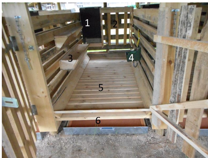
3.2. att. Barības vielu sagremošanas eksperimentam izveidotie sprosti ar redeļu grīdu (no projekta dalībnieku arhīva).
