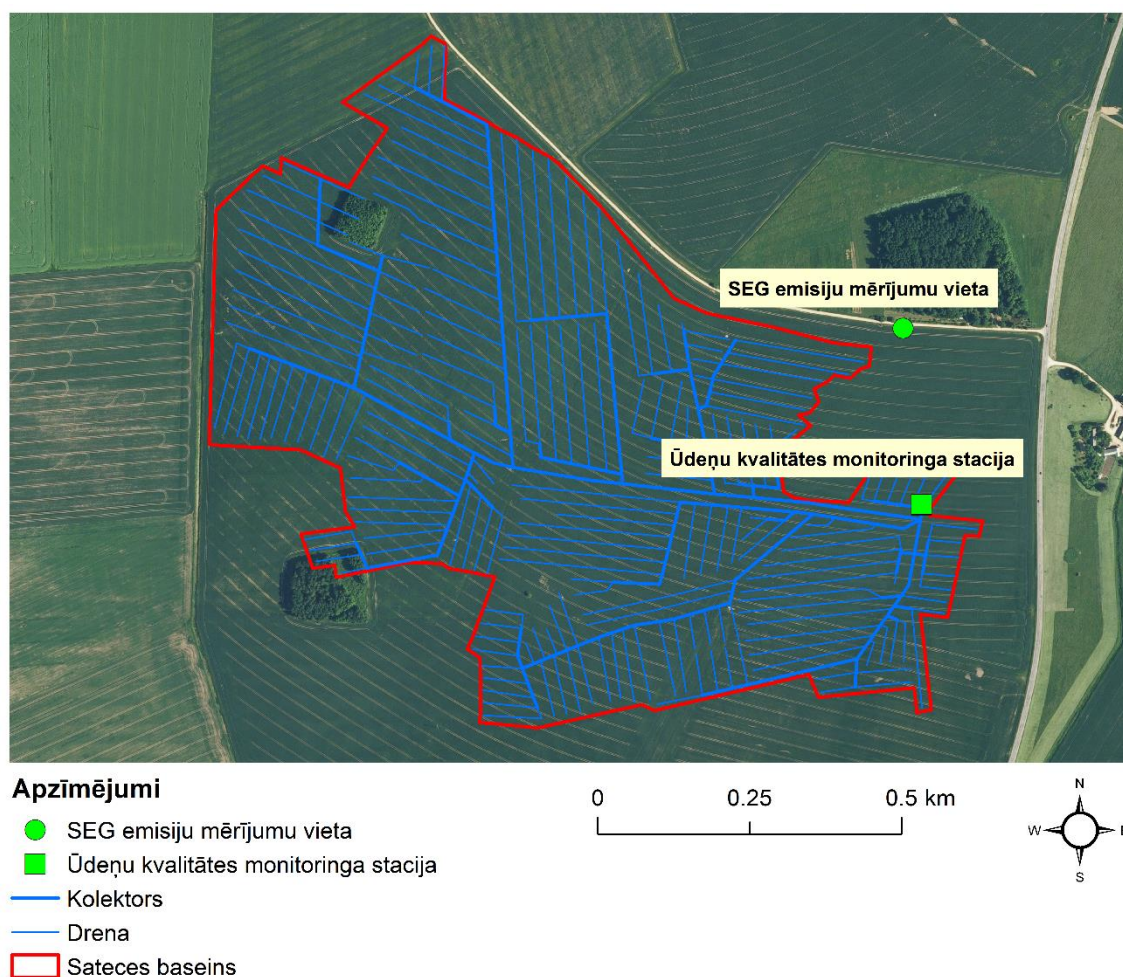
7. att. SEG emisiju mērījumu un ūdeņu paraugu ievākšanas vietas Bērzes monitoringa stacijā.
