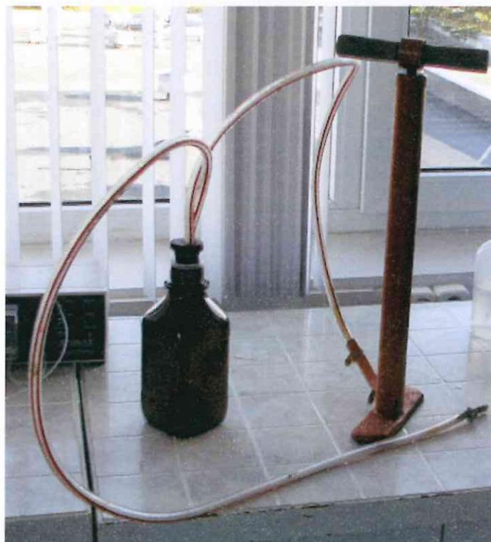
Att. 7: Sūknis augsnēs ūdeņu izsūknēšanai.
