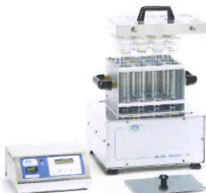
Att. 11: Mineralizācijas iekārta BLOC-DIGEST 12.
