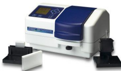
Att. 9: Spektrofotometrs Jenway 6300.
