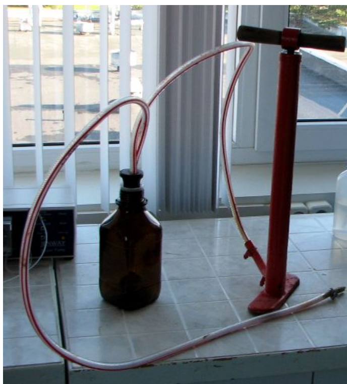
Att. 7: Sūkņis augsnes ūdeņu izsūkņēšanai.
