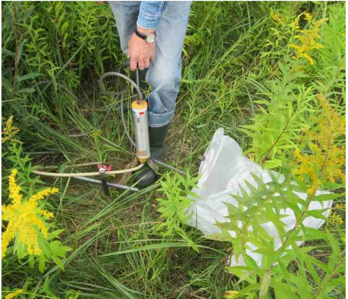
5.4. attēls. Gāzu parauga ņemšanas aprīkojuma komplekts parauga noņemšanas slēgumā, ar zondi, kas ievietota atkritumu slāņa parauga noņemšanai
