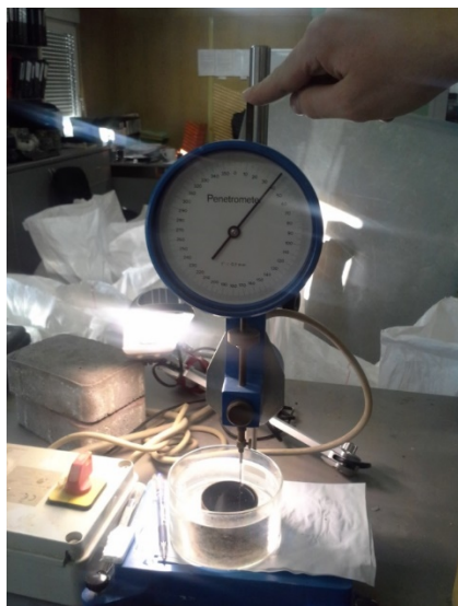
Ilustrācija 54. Bitumena penetrācijas noteikšana ar penetrometru
