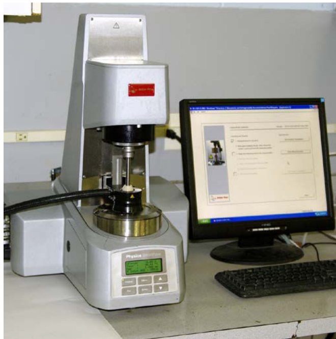
Ilustrācija 57. Performance Grade noteikšana (DSR iekārta)
