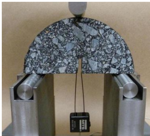
Ilustrācija 6. Puscilindra lieces tests
