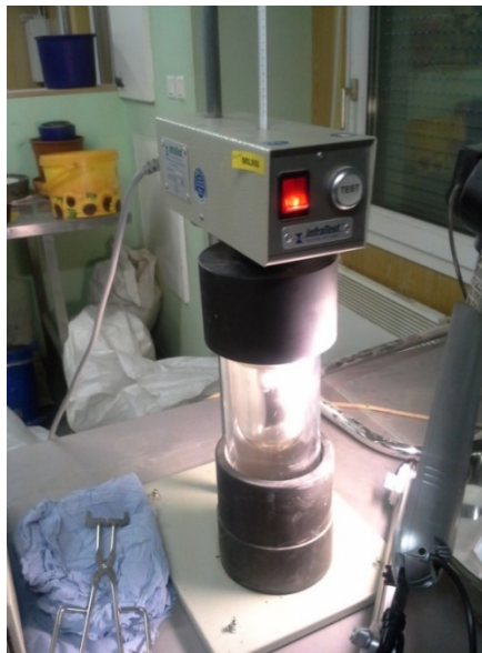
Ilustrācija 21. Fraasa trausluma temperatūras noteikšana
