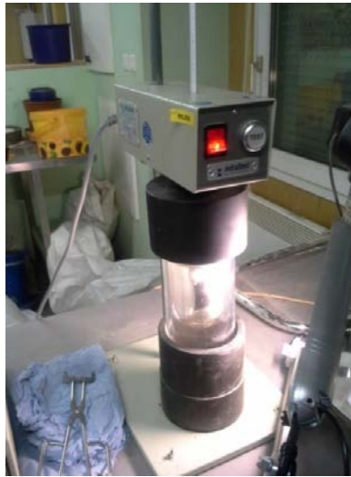
Ilustrācija 56. Fraasa trausluma temperatūras noteikšana
