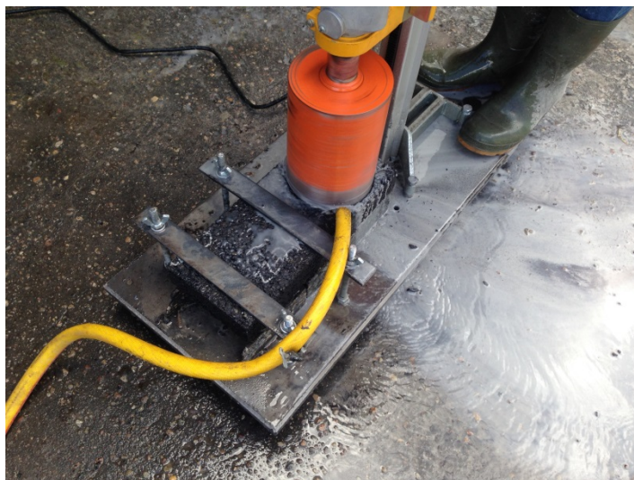
Ilustrācija 29. Puscilindra lieces testa paraugu urbšana
