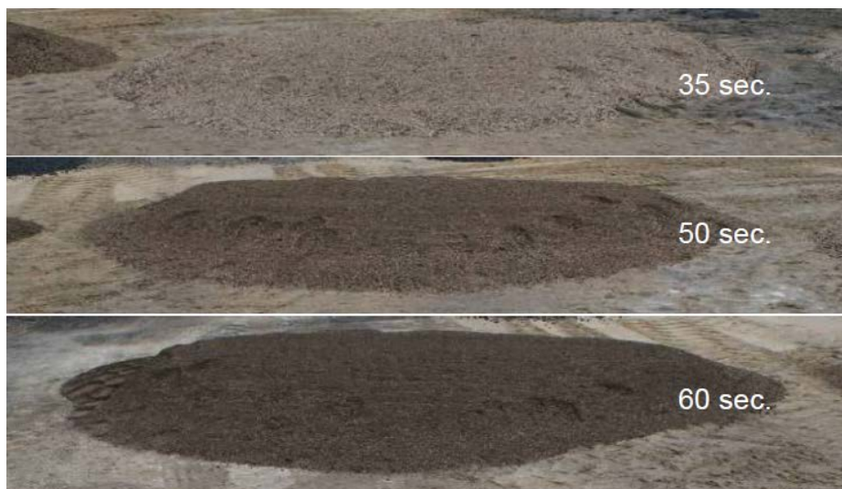
Ilustrācija 10. 25% frēzētā asfalta sajukšana ar gaišas krāsas minerālmateriāliem, lai noteiktu optimālo maisīšanas ilgumu [38]
