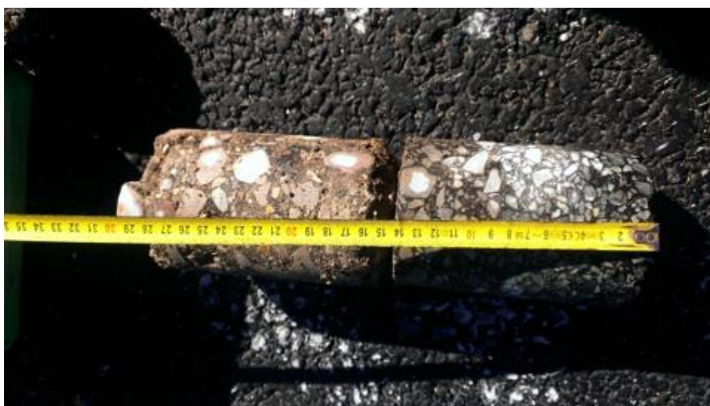
8-5 attēls. No urbuma iegūtais reciklētās kārtas un asfalta paraugs
