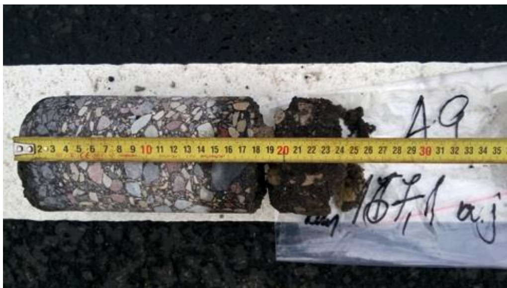
8-7 attēls. Izurbtais asfalta un reciklētās kārtas paraugs 167,1 km
