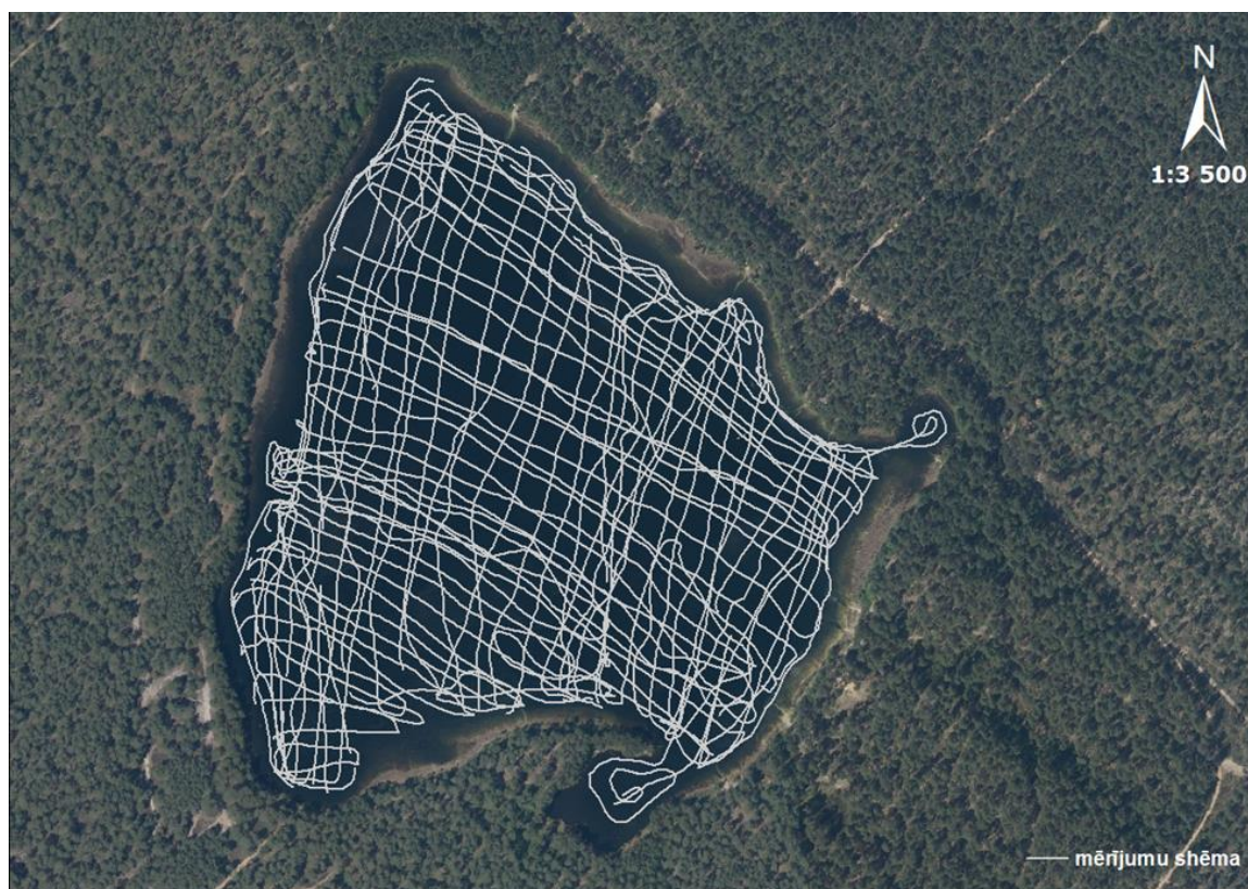
9.attēls. Ģeoradara sistēmas mērījumu shēma Ummja ezera teritorijā.
