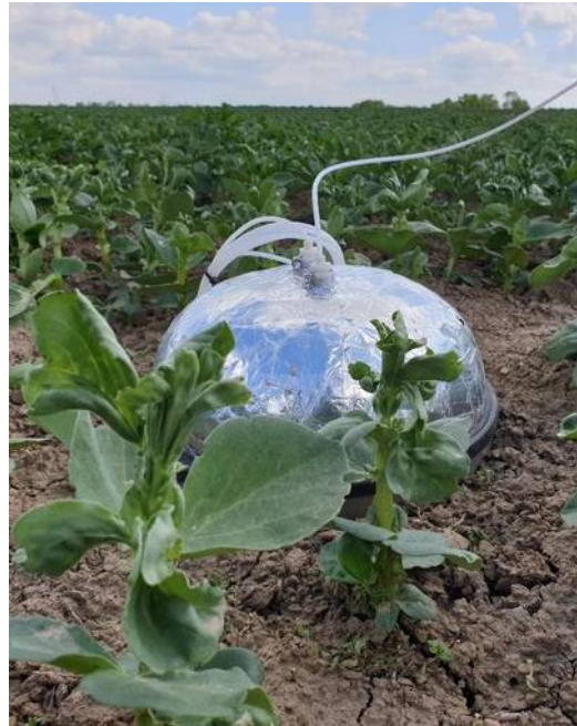
Att. 3. Kamera gāzu mērījumu veikšanai (autors: K.Valujeva).
