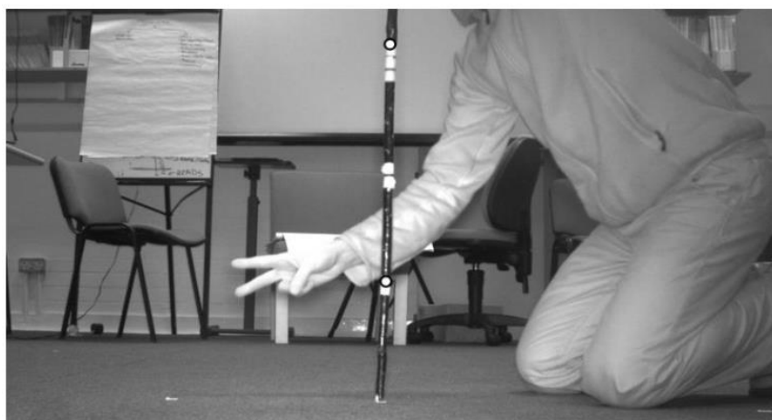
17.attēls. Kameras kalibrācijas attēls ar mietu 2 metru attālumā. EOW protokols.
