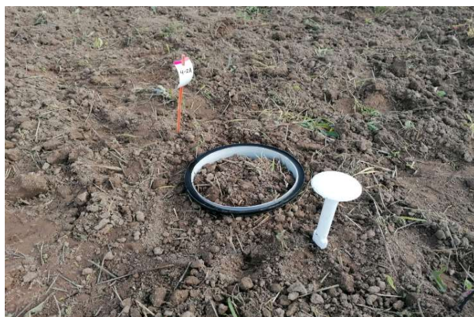
Gredzens un augsnes mitruma/temperatūras sensors
