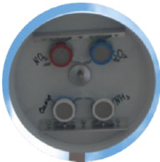
5.5. attēls. Membrānas tipa pasīvie gaisa paraugu savācēji (avots: http://icp-forests.net/page/icp-forests-manual ).
