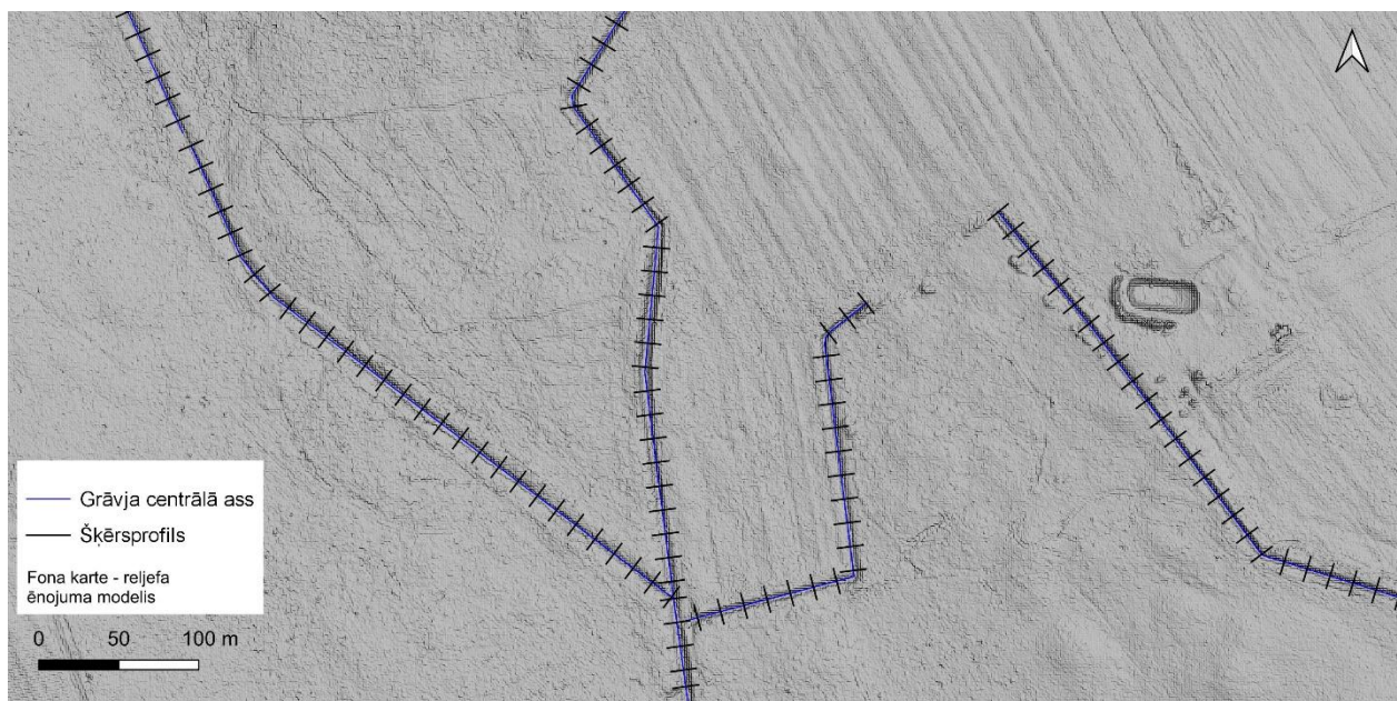
1. attēls. Grāvju sistēma un uz grāvju centrālajām asīm izvietoti šķērsprofili automātiskai grāvju parametru identificēšanai.
