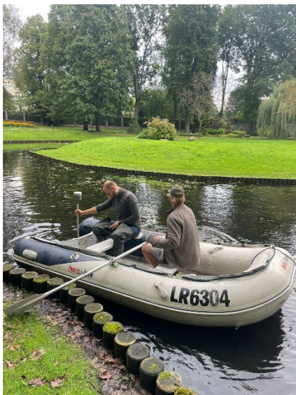
1.Foto. Diķa dziļuma mērījumi ar GNSS iekārtu.
