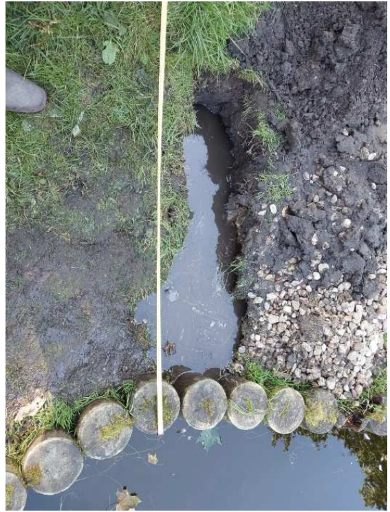
Attēls Nr.9 Skats uz skatrakumu, tai skaitā identificēto dolomīta šķembu aizbērums.
