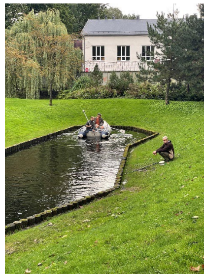
4.Foto. Dziļuma mērījumi ar GNSS iekārtu
